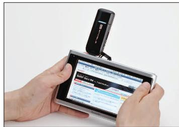
▲イー・モバイルのD31HWなどのUSBモデムを接続し、簡単な操作で使用できるようになる。
