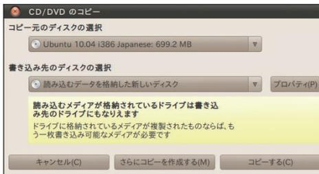
↑CDの複製もできる。1台のドライブで読み書きを行う場合は、CDの読み込み完了後にディスクをCD-Rに入れ替えよう。
