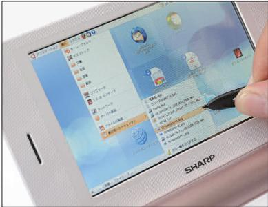
■5インチでも、ネットブックと同じ解像度を表示できる。しかもタッチパネル機能付き。モバイル用途にはこれ以上ない液晶が搭載されているのだ。
