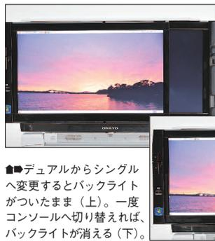
◆デュアルからシングルへ変更するとバックライトがついたまま(上)。一度コンソールへ切り替えれば、バックライトが消える(下)。
