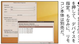
赤外線リモコンの受信部を有効にするには、「gnome-lirc-properties」を追加し、「システム」システム設定「Infrared」から設定を変更すればオーケーだ。
