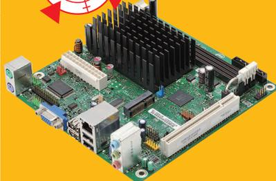
■GPUを内蔵したAtom D510(1.66GHz、デュアルコア)を搭載。大型のヒートシンクを搭載し、ファンレスで動作可能。ギガビットLANなどを装備する。
