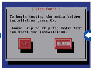
インストールメディアのテストをするか確認する画面。ここは時間がかかるので、スキップしてよい。
